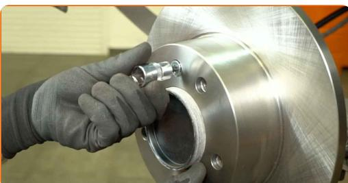
**25** Serrez la vis du disque de frein. Utilisez un embout Torx T40. Utilisez une clé dynamométrique. Couple de serrage : 14 N·m.
