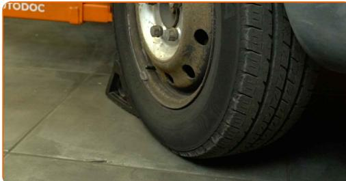
4 Desserrez les fixations de roue. Utilisez une douille à choc pour jantes de 24 mm. Utilisez une barre de force.
