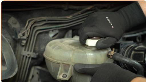
Remplacement : vase d'expansion – RENAULT Master II Camion plate-forme/Châssis. Conseil des experts d'AUTODOC :
