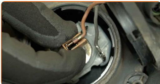
10 Tirez sur le côté le support de l'ampoule du feu antibrouillard.
