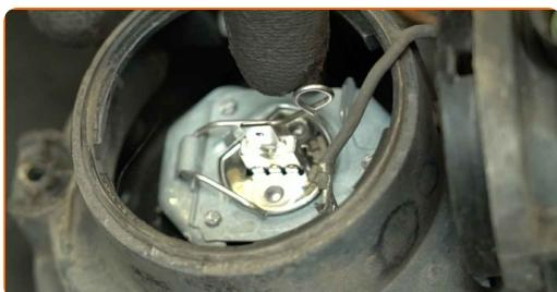
11 Retirez l'ampoule du feu antibrouillard.
