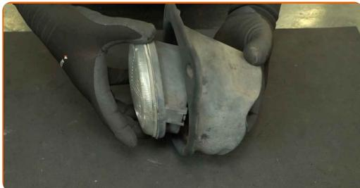
8 Retirez le couvercle arrière du feu antibrouillard en le tournant dans le sens inverse des aiguilles d'une montre.
