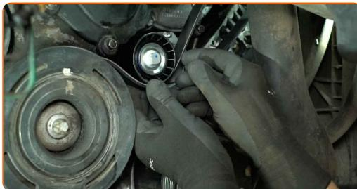
Remplacement : courroie poly V – RENAULT Master II Camion plate-forme/Châssis. AUTODOC recommande :
