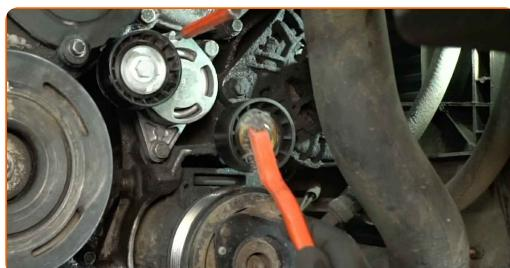
**11** Dévissez le galet tendeur de la poulie de tension. Utilisez une douille de 13 mm. Utilisez une clé à cliquet. Utilisez une rallonge de douille pour joint en U.
