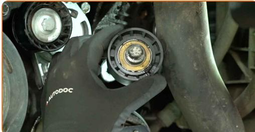
**14** Dévissez les fixations du tendeur de courroie. Utilisez une douille de 13 mm. Utilisez une clé à cliquet. Utilisez une rallonge de douille pour joint en U.
