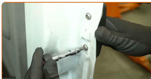
**3** Retirez les boulons de fixation.
