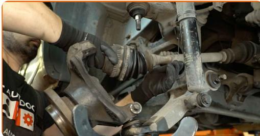
Remplacement : roulement de roue – RENAULT Master Pro Van (FH\_\_). Les professionnels recommandent :
