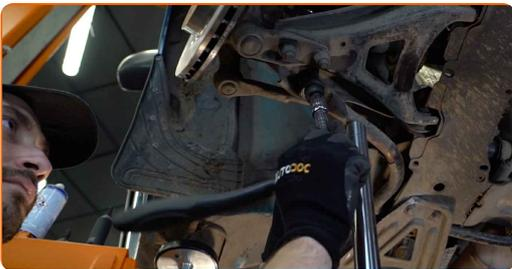
13 Retirez le pont élévateur de sous la barre stabilisatrice.
