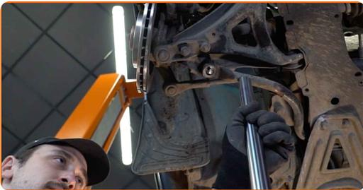
12 Resserez la fixation de la biellette de la barre stabilisatrice. Utilisez la mèche Torx T45. Utilisez une douille n° 13. Utilisez une clé dynamométrique. Serrez-le jusqu'à 35 Nm.
