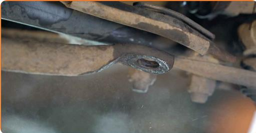
10 Installez une nouvelle barre, serrez les attaches.
