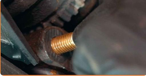
22 Vissez la fixation reliant le joint à rotule au porte-fusée. Utilisez une clé mixte de No.16. Utilisez une douille n° 16. Utilisez une clé à cliquet.
