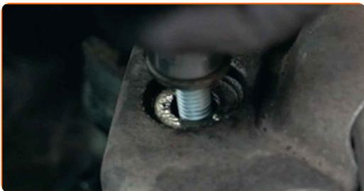
7 Dévissez le support moteur de sa semelle. Utilisez une douille n° 16. Utilisez une clé à cliquet.
