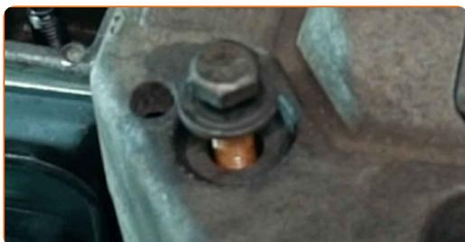
**17** Vissez les fixations du support de montage du moteur. Utilisez une douille n° 16. Utilisez une clé à cliquet.
