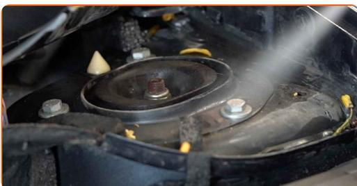
**5** Dévissez la fixation supérieure du support d'amortisseur. Utilisez une douille n° 13. Utilisez une clé à cliquet.
