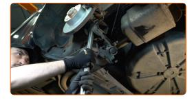
Dévissez l'attache inférieure de l'amortisseur. Utilisez une clé mixte de No.18. Utilisez une douille n° 18. Utilisez une clé à cliquet. Utilisez un porte-taraud.
