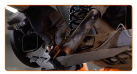
Vissez le couvercle plastique de protection de l'essieu arrière. Utilisez une douille n° 10. Utilisez une clé à cliquet.
