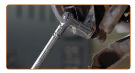
Nettoyez les fixations de l'amortisseur. Utilisez de la graisse au cuivre.
