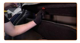
Dévissez l'attache supérieure de l'amortisseur. Utilisez une douille n° 16. Utilisez une clé à cliquet.
