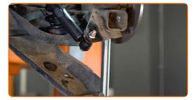
Serrez l'attache inférieure de l'amortisseur. Utilisez une clé mixte de No.18. Utilisez une douille n° 18. Utilisez une clé dynamométrique. Serrez-le jusqu'à 105 Nm.
