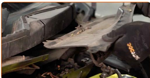
8 Dévissez les boulons de fixation du compartiment du filtre. Servez-vous d'un tournevis Phillips.
