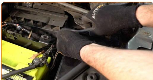
9 Surélevez un peu le couvercle de protection supérieur. Retirez le compartiment du filtre à air.
