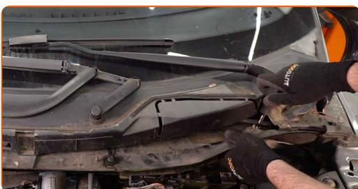
18 Installez la grille d'auvent sur le côté gauche.
