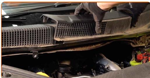
6 Dévissez les boulons de fixation du couvercle de protection. Utilisez une douille n° 10. Utilisez une clé à cliquet.
