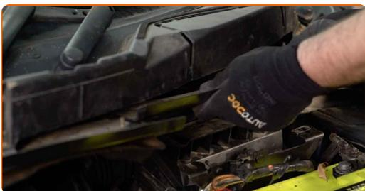
17 Serrez les boulons de fixation du couvercle de protection. Utilisez une douille n° 10. Utilisez une clé à cliquet.
