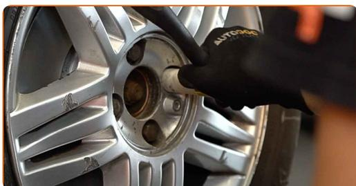
**22** Abaissez la voiture et serrez les boulons de roue en ordre croisé. Utilisez une clé dynamométrique. Serrez-le jusqu'à 110 Nm.
