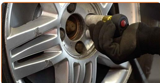
**24** Abaissez la voiture et serrez les boulons de roue en ordre croisé. Utilisez une clé dynamométrique. Serrez-le jusqu'à 110 Nm.
