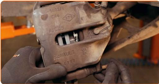
28 Serrez les fixations de l'étrier de frein. Utilisez une clé mixte de No.17 Utilisez une douille n° 13. Utilisez une clé dynamométrique. Serrez-le jusqu'à 32 Nm.
