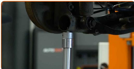
**13** Dévissez l'attache inférieure de l'amortisseur. Utilisez une douille n° 18. Utilisez une clé à cliquet.
