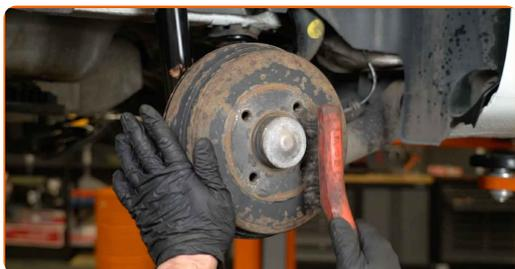
**32** Appliquez du produit sur la surface de contact entre la jante et le tambour de frein. Utilisez de la graisse au cuivre.
