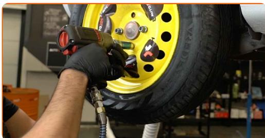
**35** Abaissez la voiture et serrez les boulons de roue en ordre croisé. Servez-vous d'une douille à choc pour roue N°17. Utilisez une clé dynamométrique. Serrez-le jusqu'à 105 Nm.
