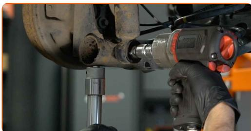
**14** Retirez l'écrou de fixation.
