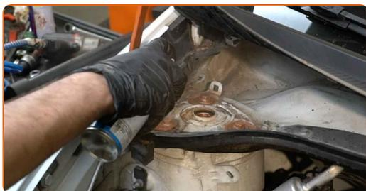
**68** Installez le bouchon de protection du support d'amortisseur.
