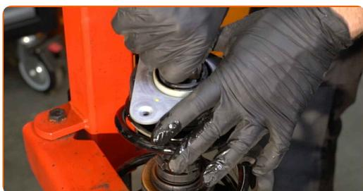
**41** Serrez l'écrou de l'entretoise d'amortisseur due la tige de piston. Utilisez une douille n° 18. Utilisez la clé HEX n° H6. Utilisez une clé dynamométrique. Serrez-le jusqu'à 62 Nm.
