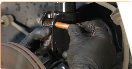
**51** Vissez la fixation qui relie la jambe d'amortisseur à la fusée d'essieu. Utilisez une clé mixte de No.18 Utilisez une douille n° 18. Utilisez une clé à cliquet.
