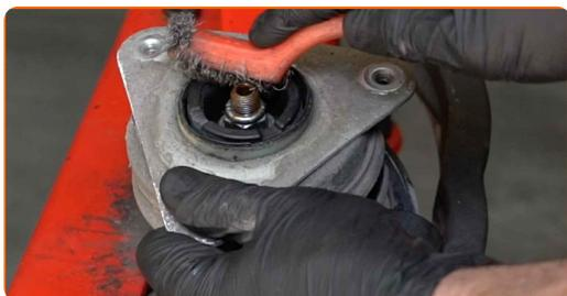
**32** Retirez l'écrou de la tige de piston de l'entretoise. Utilisez la clé HEX n° H6. Utilisez une douille n° 18. Utilisez une clé à cliquet.
