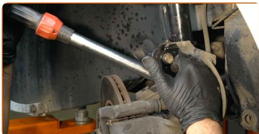
**59** Appliquez du produit sur les fixations de l'amortisseur. Utilisez de la graisse au cuivre.
