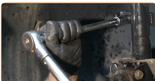
**58** Serrez les fixations inférieures qui relient l'amortisseur à la fusée d'essieu. Utilisez une clé mixte de No.18 Utilisez une douille n° 18. Utilisez une clé dynamométrique. Serrez-le jusqu'à 105 Nm.
