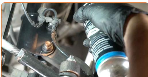
**60** Appliquez du produit sur la zone de contact entre le disque de frein et la jante. Utilisez de la graisse au cuivre.
