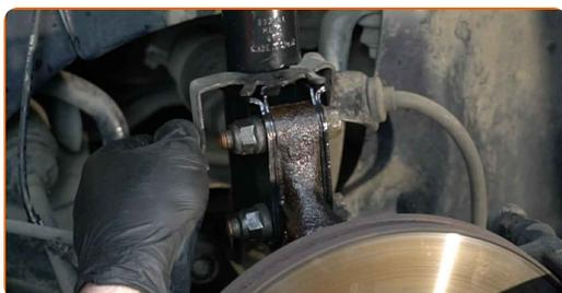
**54** Serrez le collier de serrage du flexible de frein de l'entretoise de l'amortisseur. Utilisez une douille n° 10. Utilisez une clé à cliquet.
