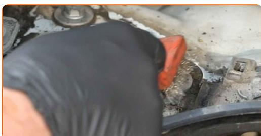
9 Dévissez la fixation supérieure du support d'amortisseur. Utilisez une douille n° 13. Utilisez une clé à cliquet.
