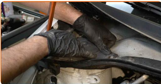
**69** Vissez les fixations du couvercle du support de la jambe de suspension. Utilisez une douille n° 10. Utilisez une clé à cliquet.
