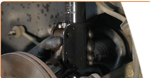
**50** Installez les boulons de fixation.
