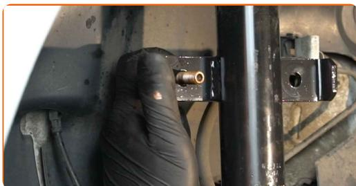
**57** Serrez la fixation reliant la biellette à l'amortisseur. Utilisez une douille n° 16. Utilisez une clé dynamométrique. Serrez-le jusqu'à 44 Nm.
