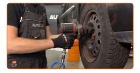
Abaissez la voiture et serrez les boulons de roue en ordre croisé. Utilisez une clé dynamométrique. Serrez-le jusqu'à 90 Nm.
