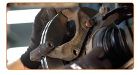
Serrez le support de l'étrier de frein. Utilisez une douille n° 18. Utilisez une clé dynamométrique. Serrez-le jusqu'à 100 Nm.
