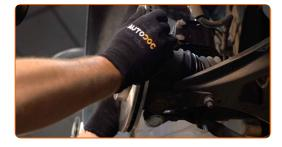
Serrez l'attache du disque de frein. Utilisez la mèche Torx T40. Utilisez une clé dynamométrique. Serrez-le jusqu'à 15 Nm.
