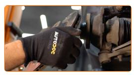
Nettoyez le moyeu. Utilisez une brosse métallique. Traitez la surface de contact. Utilisez de la graisse au cuivre.
