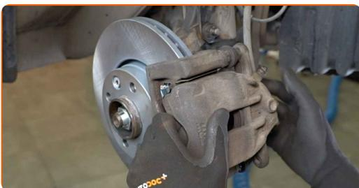
**20** Installez les boulons de fixation.
