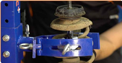
18 Retirez l'écrou de la tige de piston de l'entretoise. Utilisez la clé HEX n° H6. Utilisez une clé mixte de No.14. Utilisez une clé à cliquet.
