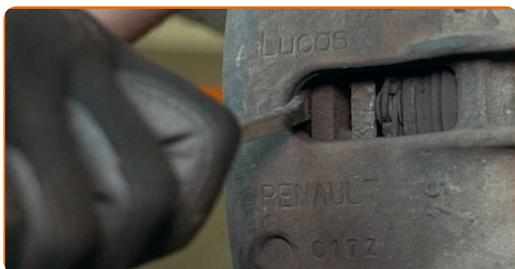
10 Dévissez l'attache du support d'étrier. Utilisez une douille n° 18. Utilisez une clé à cliquet.
