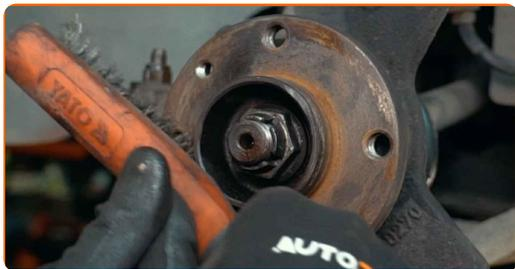
63 Traitez la surface de contact. Utilisez de la graisse au cuivre.
