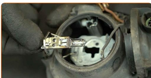
12 Installez l'ampoule dans le nouveau feu antibrouillard.
