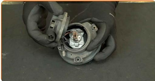
9 Détachez le connecteur de l'ampoule du feu antibrouillard.
