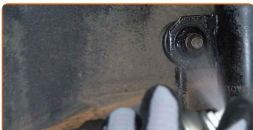
**12** Détachez la fixation reliant le câble du capteur ABS à l'amortisseur.
