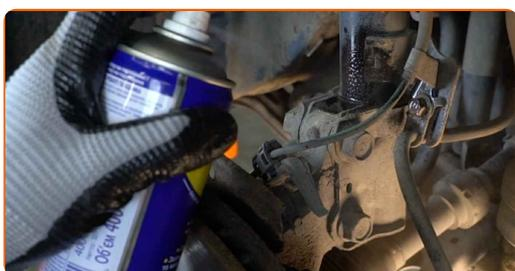
**14** Débranchez le support du flexible de frein de l'entretoise de l'amortisseur. Dévissez la fixation du capteur ABS. Utilisez une douille n° 12. Utilisez une clé à cliquet.
