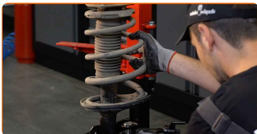
Remplacement : jambe de suspension – Lexus RX XU30. Les professionnels recommandent :
