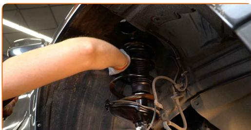
**42** Vissez l'attache supérieure du support de l'amortisseur. Ne serrez pas trop.
