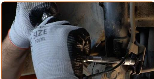
**15** Dévissez la fixation reliant la biellette à l'amortisseur. Utilisez une douille n° 17. Utilisez une clé à cliquet.
