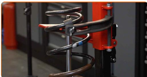
**36** Installez la coupelle, le manchon et la butée de suspension sur l'amortisseur.
