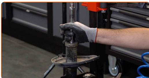
Remplacement : jambe de suspension – Lexus RX XU30. Les experts d'AUTODOC recommandent :
