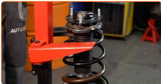
**39** Lubrifiez la barre d'amortisseur. Utilisez de la graisse au cuivre.
