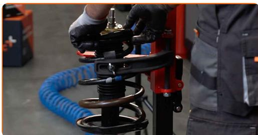
**37** Serrez l'écrou de l'entretoise d'amortisseur due la tige de piston. Utilisez une douille n° 21. Utilisez une clé à chaine. Utilisez une clé dynamométrique. Serrez-le jusqu'à 60 Nm.
