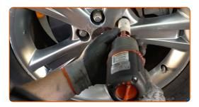
Abaissez la voiture et serrez les boulons de roue en ordre croisé. Servez-vous d'une douille à choc pour roue N°21. Utilisez une clé dynamométrique. Serrez-le jusqu'à 103 Nm.
