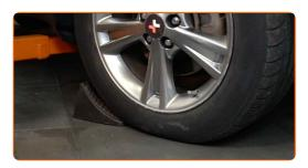
Desserrez les boulons de fixation de la roue. Servez-vous d'une douille à choc pour roue N°21.
