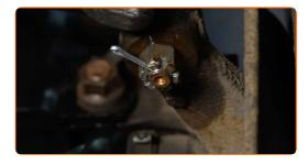
Serrez l'écrou de bloquage de l'extrémité de la barre. Utilisez une clé mixte de No.19 Utilisez une clé dynamométrique. Serrez-le jusqu'à 74 Nm.
