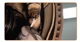
Dévissez l'écrou d'attache d'extrémité à la fusée d'essieu. Utilisez une douille n° 17. Utilisez un porte-taraud.
