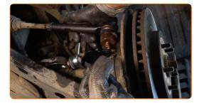
Vissez l'écrou de fixation reliant l'embout de biellette à la fusée d'essieu. Utilisez une douille n° 17. Utilisez une clé à cliquet.
