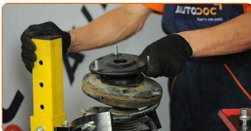
**34** Serrez l'écrou de l'entretoise d'amortisseur due la tige de piston. Utilisez une douille n° 19. Utilisez une clé dynamométrique. Serrez-le jusqu'à 64 Nm.
