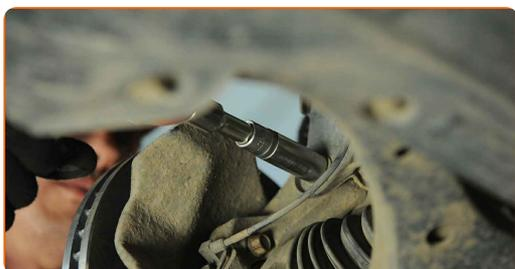
**11** Débranchez les fils du capteur d'ABS.
