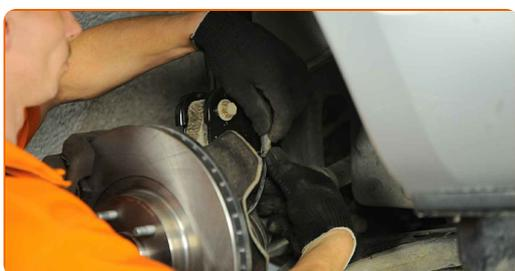
**48** Serrez les fixations inférieures qui relient l'amortisseur à la fusée d'essieu. Utilisez une clé mixte de No.19 Utilisez une douille n° 17. Utilisez une clé dynamométrique. Serrez-le jusqu'à 152 Nm.
