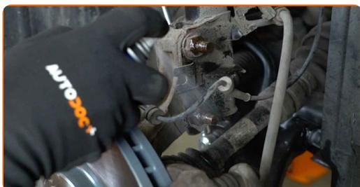
**10.1** Dévissez les fixations reliant la jambe de suspension à la fusée d'essieu.
