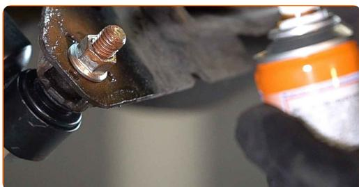
**24** Vissez le couvercle plastique de protection de l'essieu arrière. Utilisez une douille n° 10. Utilisez une clé à cliquet.
