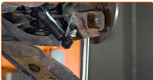
21 Serrez l'attache inférieure de l'amortisseur. Utilisez une clé mixte de No.18. Utilisez une douille n° 18. Utilisez une clé dynamométrique. Serrez-le jusqu'à 105 Nm.
