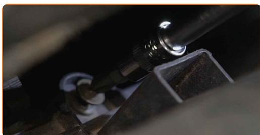
**4** Relâchez le collier de fixation reliant le conduit d'air au boîtier de filtre à air. Utilisez des pinces de clic-R.
