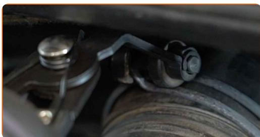
**5** Détachez le boîtier du conduit d'air du boîtier du filtre à air.
