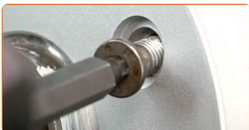
**25** Serrez l'attache du disque de frein. Utilisez la clé HEX n° H6. Utilisez une clé dynamométrique. Serrez-le jusqu'à 10 Nm.
