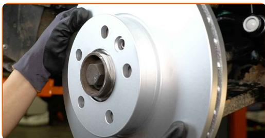
**24** Installez l'écrou de fixation.
