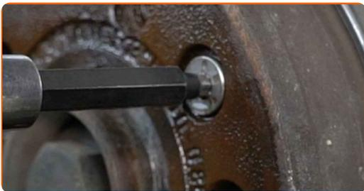
**19** Retirez l'écrou de fixation.
