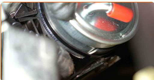
**20** Raccordez le tuyau au filtre à carburant.
