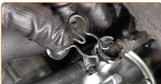
**8** Débranchez le tuyau du filtre à carburant.
