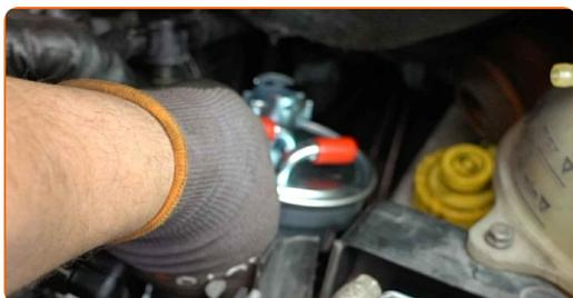
Remplacement : filtre à carburant – SEAT Alhambra (7V8, 7V9). Les professionnels recommandent :
