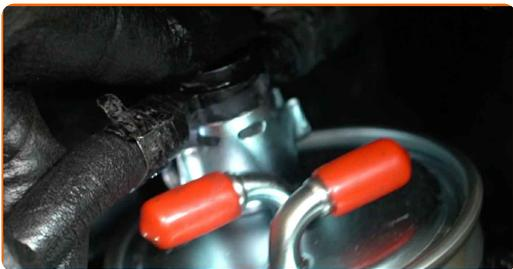
**18** Fixez le tuyau du filtre à carburant à l'aide du clip de retenue.
