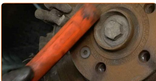
**27** Appliquez du produit sur la zone de contact entre le disque de frein et la jante. Utilisez du lubrifiant céramique.
