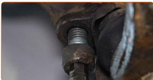
**73** Serrez les fixations reliant le joint à rotule à la fusée d'essieu. Utilisez la clé HEX n° H8. Utilisez une clé dynamométrique. Serrez-le jusqu'à 55 Nm.
