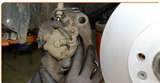
**71** Installez les boulons de fixation.
