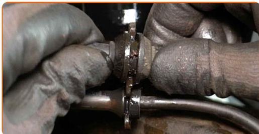
**78** Appliquez du produit sur les fixations de la rotule. Utilisez de la graisse au cuivre.
