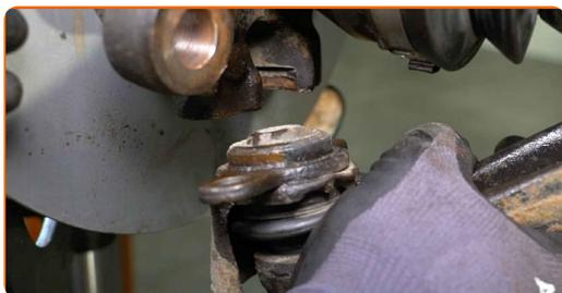
**35** Détachez l'arbre de transmission de la fusée d'essieu.
