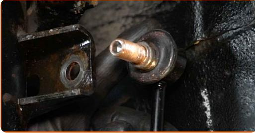
**18** Débranchez le câblage du capteur ABS.
