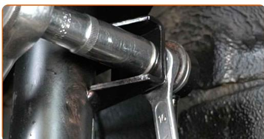
**75** Serrez les fixations inférieures de la jambe de suspension. Utilisez une douille n° 18. Utilisez une clé dynamométrique. Serrez-le jusqu'à 110 Nm.
