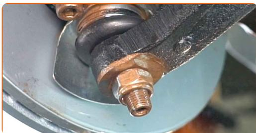
**79** Appliquez du produit sur la fixation reliant la jambe de suspension à la fusée d'essieu. Utilisez de la graisse au cuivre.
