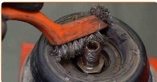
**43** Retirez l'écrou de la tige de piston de l'entretoise. Utilisez une douille pour écrou de jambe de suspension de 21 mm. Utilisez la clé HEX n° H7. Utilisez une clé à cliquet.
