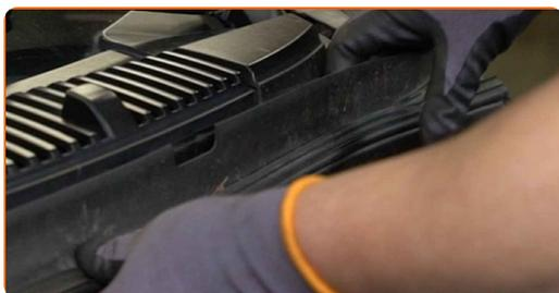
**5** Dévissez les fixations du panneau en plastique. Utilisez une douille n° 10. Utilisez une clé à cliquet.
