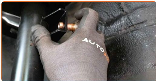
**74** Serrez la fixation reliant la biellette à l'amortisseur. Utilisez une clé mixte de No.16 Utilisez une douille n° 19. Utilisez une clé dynamométrique. Serrez-le jusqu'à 100 Nm.
