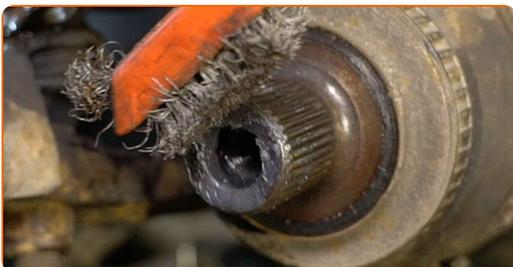
**57** Appliquez du produit sur les cannelures de joint de l'arbre de transmission. Utilisez de la graisse au cuivre.
