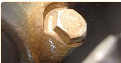
**80** Appliquez du produit sur la fixation qui relie la biellette de barre stabilisatrice à la jambe de suspension. Utilisez de la graisse au cuivre.
