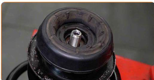
**50** Serrez l'écrou de l'entretoise d'amortisseur due la tige de piston. Utilisez une douille pour écrou de jambe de suspension de 21 mm. Utilisez la clé HEX n° H7. Utilisez une clé dynamométrique. Serrez-le jusqu'à 60 Nm.
