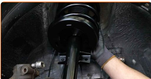
**59** Vissez les fixations supérieures du support de la jambe de suspension. Ne serrez pas trop.
