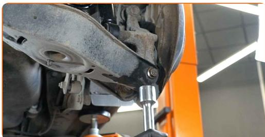
**27** Vissez la fixation reliant le bras de commande à la fusée arrière. Utilisez une clé mixte de No.18 (2 pièces).
