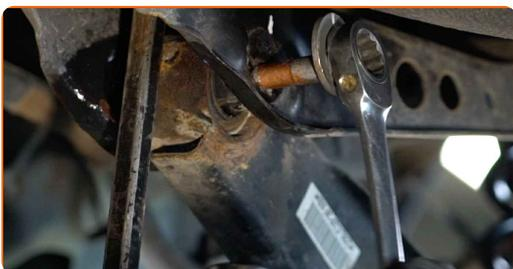
**22** Ajustez la position de l'écrou d'alignement.
