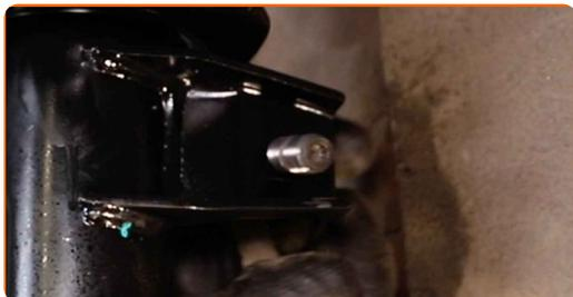
**69** Resserez la fixation de la biellette de la barre stabilisatrice. Utilisez une douille n° 18. Servez vous de la douille XZN n°6. Utilisez une clé à cliquet.
