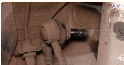
**18** Débranchez les fils du capteur d'ABS.
