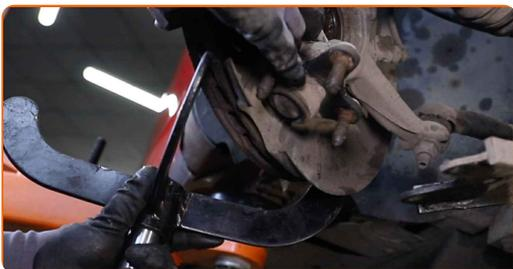
**32** Relâchez la fixation inférieure assurant la connexion entre la jambe d'amortisseur et le porte-fusée. Servez-vous d'une douille spéciale pour retirer l'amortisseur.
