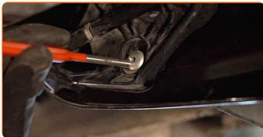
**23** Installez l'attache de la barre au stabilisateur et serrez-la. Utilisez une clé mixte de No.16 Utilisez une douille n° 16. Servez vous de la douille XZN n°6. Utilisez une clé dynamométrique. Serrez-le jusqu'à 45 Nm.
