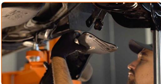
**14** Dévissez l'attache entre le support et le bras. Utilisez une douille n° 18. Utilisez une clé à cliquet.
