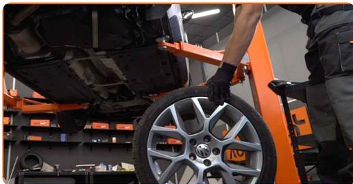
Remplacement : bras oscillant inférieur de suspension arrière – SEAT Altea (5P1). Les experts d'AUTODOC recommandent :
