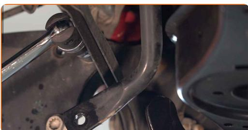
**12** Dévissez la fixation reliant le bras longitudinal à la carrosserie. Utilisez une douille n° 15. Utilisez une clé à cliquet.
