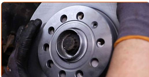
**23** Serrez l'attache du disque de frein. Utilisez la mèche Torx T30. Utilisez une clé dynamométrique. Serrez-le jusqu'à 4 Nm.
