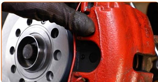
**39** Appliquez du produit sur la zone de contact entre le disque de frein et la jante. Utilisez du lubrifiant céramique.
