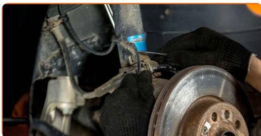
**10** Retirez les bouchons anti-poussière des goupilles de guidage de l'étrier de frein. Utilisez un tournevis plat.
