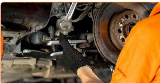
**9.1** Débranchez les câbles et le flexible de frein du support de la fusée d'essieu.
