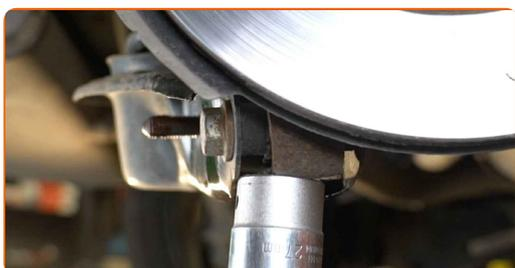
**35** Installez les boulons de fixation.
