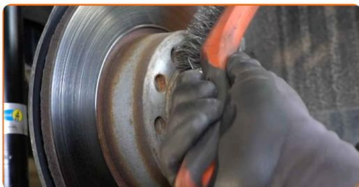
**47** Appliquez du produit sur la zone de contact entre le disque de frein et la jante. Utilisez du lubrifiant céramique.
