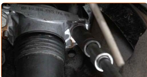
**37** Appliquez du produit sur les fixations du support de l'amortisseur. Utilisez de la graisse au cuivre.
