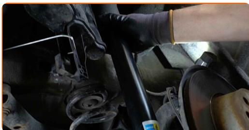
**33** Installez l'écrou de fixation.
