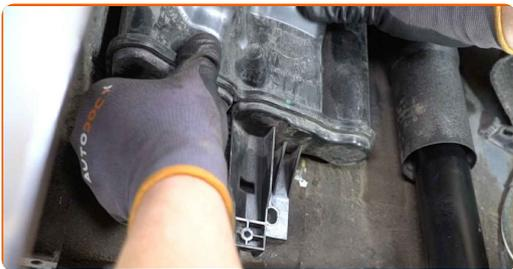
**39** Serrez la fixation du réservoir à charbon actif. Utilisez une douille n° 13. Utilisez une clé dynamométrique. Serrez-le jusqu'à 12 Nm.
