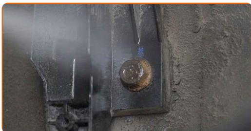
**13** Dévissez la fixation du réservoir à charbon actif. Utilisez une douille n° 13. Utilisez une clé à cliquet.
