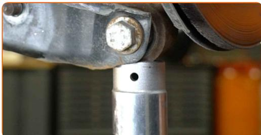
**19** Retirez l'écrou de fixation.
