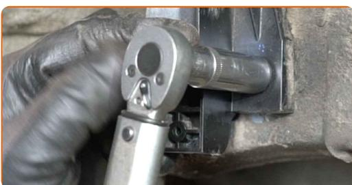
**40** Appliquez du produit sur la fixation du réservoir à charbon actif. Utilisez de la graisse au cuivre.
