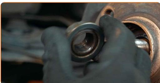
**16** Nettoyez les fixations assurant la connexion entre la jambe d'amortisseur et le porte-fusée. Nettoyez la fixation reliant l'embout de biellette de direction à la fusée d'essieu. Utilisez une brosse métallique. Servez vous de l'aérosol WD-40.
