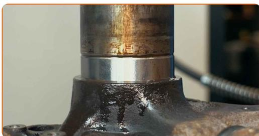
Remplacement : roulement de roue – SEAT AROSA (6H). Conseil :
