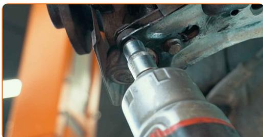
**49** Installez l'écrou de fixation.
