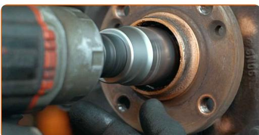
**15** Retirez l'écrou de fixation.
