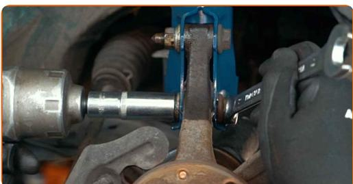
**20** Retirez l'écrou de fixation.
