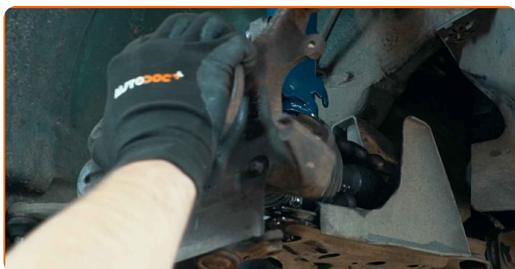
**47** Attachez le joint à rotule au bras de contrôle. Servez-vous d'un poinçon effilé.
