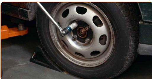
**4** Desserrez la fixation de l'arbre de transmission. Utilisez une douille n° 30. Utilisez un porte-taraud.
