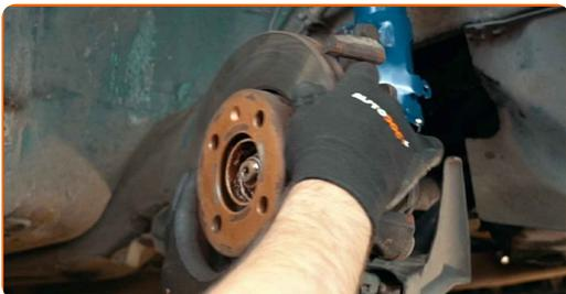
**14** Dévissez les fixations qui lient l'arbre de transmission au moyeu de roue. Utilisez une douille n° 30. Utilisez une clé à cliquet.
