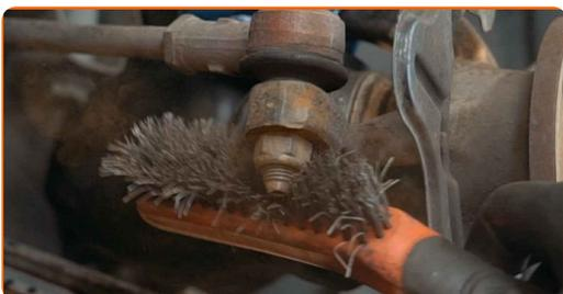
**17** Dévissez l'écrou d'attache d'extrémité à la fusée d'essieu. Utilisez une douille n° 19. Utilisez une clé à cliquet.
