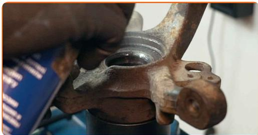
**35** Appuyez pour faire sortir le roulement de moyeu de la roue. Servez-vous d'un coffret de douilles et de roulements.
