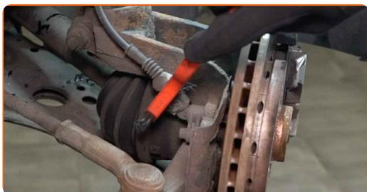
**7** Détachez le connecteur du capteur ABS. Utilisez un tournevis plat.
