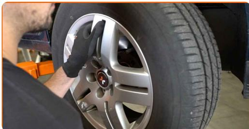
**6** Nettoyez la fixation du capteur ABS. Utilisez une brosse de nettoyage en nylon. Servez vous de l'aérosol WD-40.
