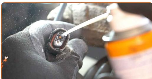
**23** Attachez le connecteur du capteur ABS.
