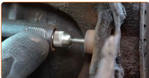
**19** Appliquez du produit sur la fixation du capteur ABS. Servez-vous d'une graisse multi-usages.
