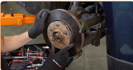
**26** Serrez l'attache du disque de frein. Utilisez la mèche Torx T30. Utilisez une clé dynamométrique. Serrez-le jusqu'à 6 Nm.
