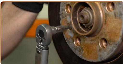
**27** Installez l'étrier de frein et fixez-le. Utilisez la clé HEX n° H7. Utilisez une clé dynamométrique. Serrez-le jusqu'à 30 Nm.
