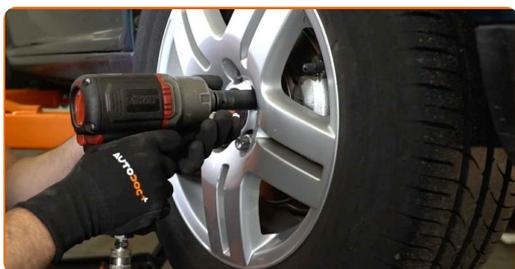
**34** Abaissez la voiture et serrez les boulons de roue en ordre croisé. Servez-vous d'une douille à choc pour roue N°17. Utilisez une clé dynamométrique. Serrez-le jusqu'à 120 Nm.
