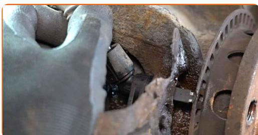
**24** Nettoyez le moyeu. Utilisez une brosse métallique. Traitez la surface de contact. Utilisez de la graisse au cuivre.
