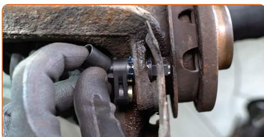
**21** Vissez la fixation reliant le capteur ABS à la fusée d'essieu. Utilisez la clé HEX n° H5. Utilisez une clé dynamométrique. Serrez-le jusqu'à 6 Nm.
