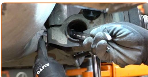
**22** Serrez l'attache inférieure de l'amortisseur. Utilisez une clé mixte de No.17 Utilisez une douille n° 17. Utilisez une clé dynamométrique. Serrez-le jusqu'à 70 Nm.
