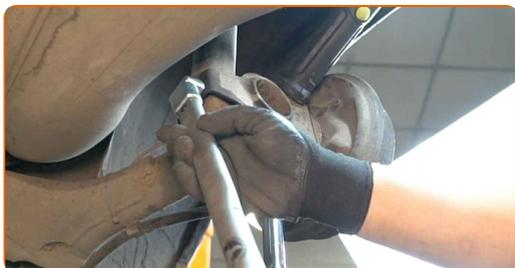
**23** Vissez l'attache supérieure du support de l'amortisseur. Ne serrez pas trop.
