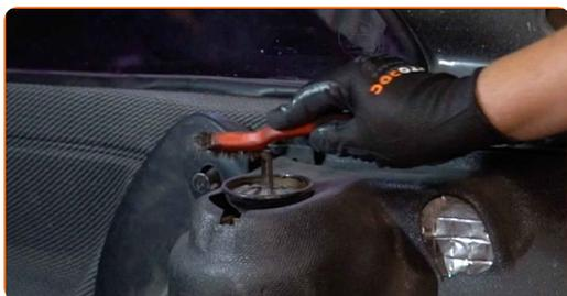
**3** Dévissez la fixation supérieure du support d'amortisseur. Utilisez une clé mixte de No.17 Servez-vous d'un embout d'amortisseur DDN°6. Utilisez une clé à cliquet.
