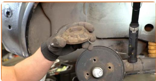
**Remplacement : coupelle d'amortisseur – SEAT Cordoba I Vario Van / Break (6K5). Les professionnels recommandent :**
