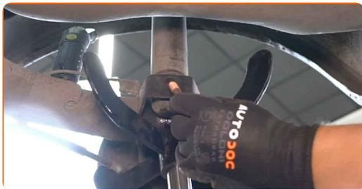
**21** Vissez la fixation inférieure de la jambe d'amortisseur. Utilisez une clé mixte de No.17 Utilisez une douille n° 17. Utilisez un porte-taraud.
