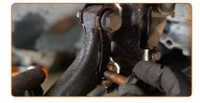
Vissez les fixations reliant la jambe de suspension à la fusée d'essieu. Utilisez une clé mixte de No.18. Utilisez une douille n° 18. Utilisez un porte-taraud.
