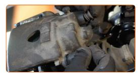
Serrez l'écrou de fixation reliant l'embout de biellette de direction à la fusée d'essieu. Utilisez une douille n° 19. Utilisez une clé dynamométrique. Serrez-le jusqu'à 35 Nm.
