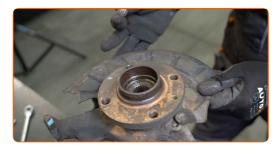
Nettoyez la bague de retenue du roulement de moyeu de la roue. Utilisez une brosse métallique. Servez vous de l'aérosol WD-40.
