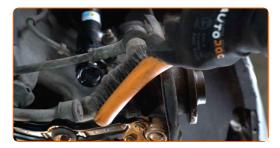
Dévissez l'écrou d'attache d'extrémité à la fusée d'essieu. Utilisez une douille n° 19. Utilisez une clé à cliquet.
