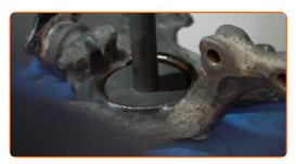
Tirez la bague de roulement intérieure du moyeu de roue. Servez-vous d'un coffret de douilles et de roulements. Utilisez un séparateur de roulement.
