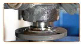
Placez la fusée d'essieu assemblée avec le moyeu de la roue dans un étau.
