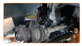
Installez les boulons de fixation.
