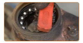
Retirez l'anneau de retenue du palier de moyeu de roue. Utilisez les pinces à anneau de retenue.
