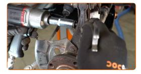
Installez l'écrou de fixation.
