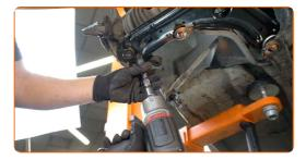
Retirez l'écrou de fixation.
