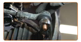
Vissez l'écrou de fixation reliant l'embout de biellette à la fusée d'essieu. Utilisez une douille n° 19. Utilisez une clé à cliquet.
