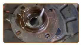
Relâchez l'étau et retirez la fusée d'essieu assemblée avec le moyeu de la roue.
