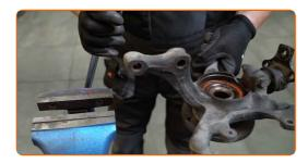
Retirez le moyeu de roue de la fusée d'essieu. Servez-vous d'un coffret de douilles et de roulements.
