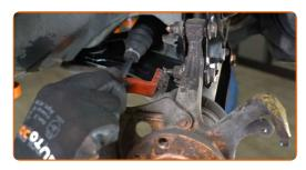
Dévissez les fixations reliant la jambe de suspension à la fusée d'essieu. Utilisez une clé mixte de No.18. Utilisez une douille n° 18. Utilisez une clé à cliquet.
