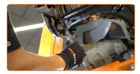
Appliquez du produit sur les fixations de l'amortisseur. Appliquez du produit sur les fixations de la rotule.
