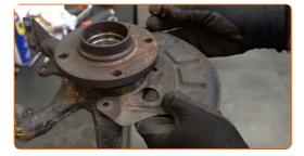
Vissez les fixations sur la protection de disques de frein. Utilisez une clé mixte de No.10.
