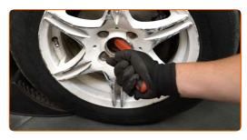
Desserrez la fixation de l'arbre de transmission. Utilisez une douille n° 30. Utilisez un porte-taraud.
