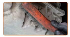
Dévissez le bouchon de vidange. Utilisez une douille n° 19. Utilisez une clé à cliquet.
