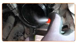
Installez un nouveau couvercle de compartiment à filtre à huile, et serrez. Utilisez une douille n° 36. Utilisez une clé dynamométrique. Serrez-le jusqu'à 25 Nm.
