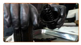
Retirez la bague d'étanchéité du boitier du filtre à huile.
