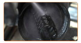
Installez une nouvelle bague d'étancheité sur l'emplacement du filtre à huile.
