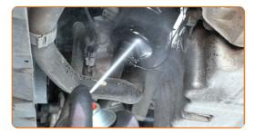
Dévissez le bouchon du compartiment du filtre, ainsi que l'ancien élément filtrant. Utilisez une douille n° 36. Utilisez une clé à cliquet.
