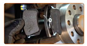
Installez l'étrier de frein et fixez-le. Utilisez une douille n° 13. Utilisez une clé mixte de No.15 Utilisez une clé dynamométrique. Serrez-le jusqu'à 35 Nm.
