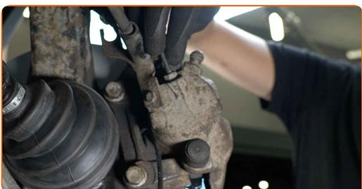
**29** Connectez le capteur d'usure des plaquettes de frein.
