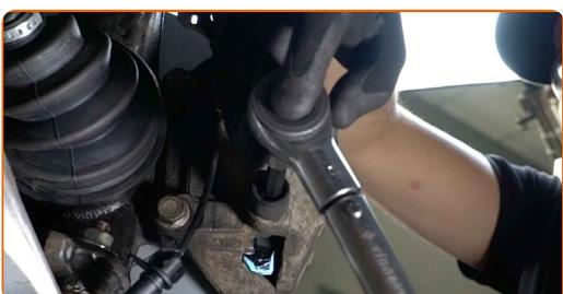
**28** Installez les bouchons anti-poussière des goupilles de guidage de l'étrier de frein.
