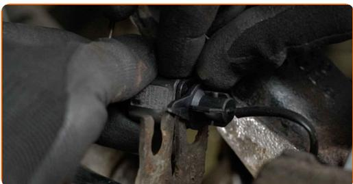
**30** Connectez le connecteur du capteur d'usure de la plaquette de frein.
