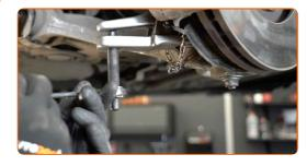
10 Retirez l'écrou de fixation.
