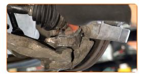
Dévissez l'attache entre le joint rotule et la fusée d'essieu. Utilisez une clé mixte de No.18
