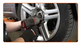
Abaissez la voiture et serrez les boulons de roue en ordre croisé. Servez-vous d'une douille à choc pour roue N°17. Utilisez une clé dynamométrique. Serrez-le jusqu'à 120 Nm.
