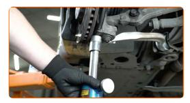
Serrez la fixation arrière qui raccorde le bras au châssis. Utilisez une clé mixte de No.18 Utilisez une douille n° 18. Utilisez une clé dynamométrique. Serrez-le jusqu'à 70 Nm.+180°
