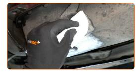
Vissez le nouveau bouchon de vidange et le resserrez. Utilisez une douille n° 19. Utilisez une clé dynamométrique. Serrez-le jusqu'à 25 Nm.
