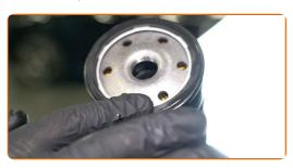
Vissez le filtre neuf en place. Utilisez la douille 74-15F. Utilisez une clé dynamométrique. Serrez-le jusqu'à 25 Nm.
