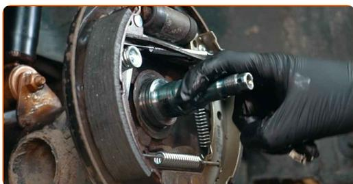
**15** Installez le nouvel ensemble tambour de frein et roulement de moyeu de roue.
